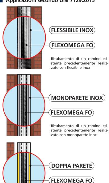
stente precedentemente realizzato in muratura ■ TUBAZIONE FLESSIBILE INOX A 4 AGGRAFFATURE anche per i diametri 50 e 60 mm:
